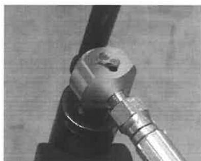
Doporučujeme během plnění držet vnější část přípojky tak, jak je zobrazeno na níže uvedených obrázcích. Tím zajistíte, aby vnější adaptér byl umístěn v poloze zcela překrývající vnitřní část, a zabráníte náhodnému uvolnění spojky předtím, než budete kartuši plnit.
