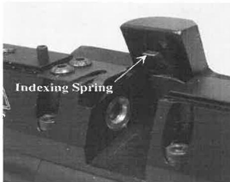
*Při demontáži nebo montáži zásobníku dbejte na to, abyste nepoškodili otáčecí pružinu.
